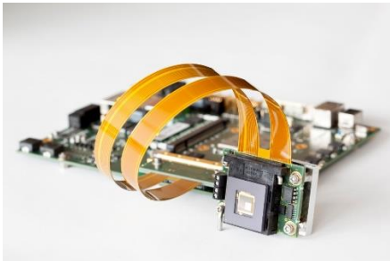
Mikrospiegelarray mit Ansteuer Elektronik ©Fraunhofer IPMS
