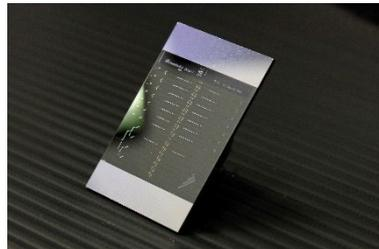
Photonischer Biosensor-Chip des Fraunhofer IPMS
