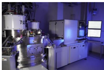
Der kryogene On-Wafer-Prober am Fraunhofer IAF charakterisiert vollautomatisch bis zu 25 ganze 200-mm- oder 300-mm-Wafer mit Bauelementen für Quantencomputer. © Fraunhofer IAF
