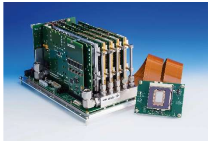
2-Achsen-Kippspiegelmodul des Fraunhofer IPMS; SLM-Chip mit Ansteuerelektronik. © Fraunhofer IPMS
