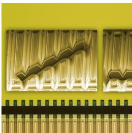
MEMS-basierter Biegeaktor V-NED.
