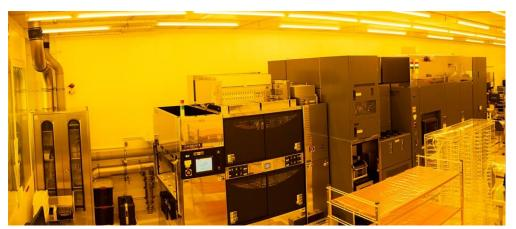
MEMS-Lithografie-Kapazitäten mit 248 nm DUV-Cluster und 365 nm iLine Stepper ©Fraunhofer IPMS
