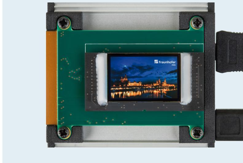
Großflächiges OLED-Mikrodisplay (Auflösung 1920 x 1200 Pixel, 120 fps, 1 Zoll Bildschirmdiagonale)
