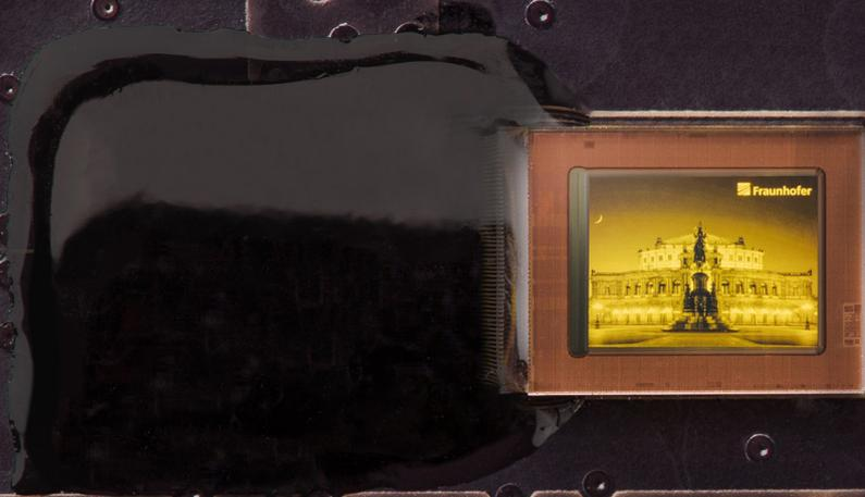
*OLED-Mikrodisplay mit einer Auflösung von 1440 x 1080 Pixel und den weltweit kleinsten Pixeln von 2,5 Mikrometern.*
