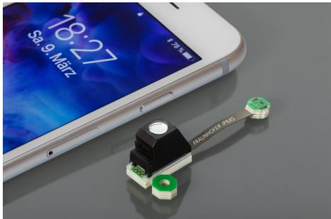
*Ultrakompaktes MEMS NIR Spektrometer für die Integration in ein Smartphone*
