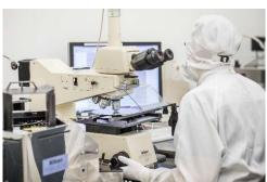
Qualitätscheck eines prozessierten Wafers ©Fraunhofer IPMS – Fotograf: Brandt
