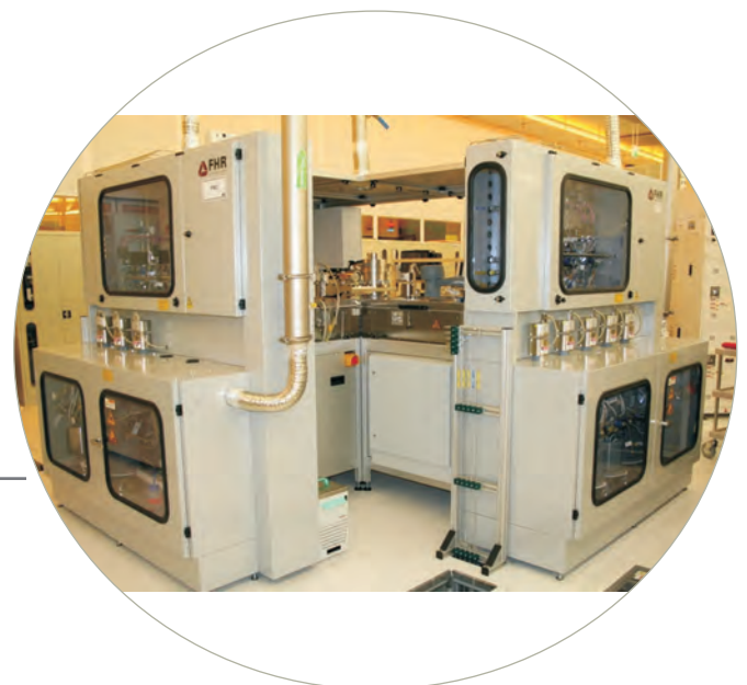
Abb. 7 Gesamtansicht der im Fraunhofer CNT-Reinraum installierten ALD-Forschungsanlage fig. 7 View on research ALD-tool (FHR) installed in the Fraunhofer CNT clean room
