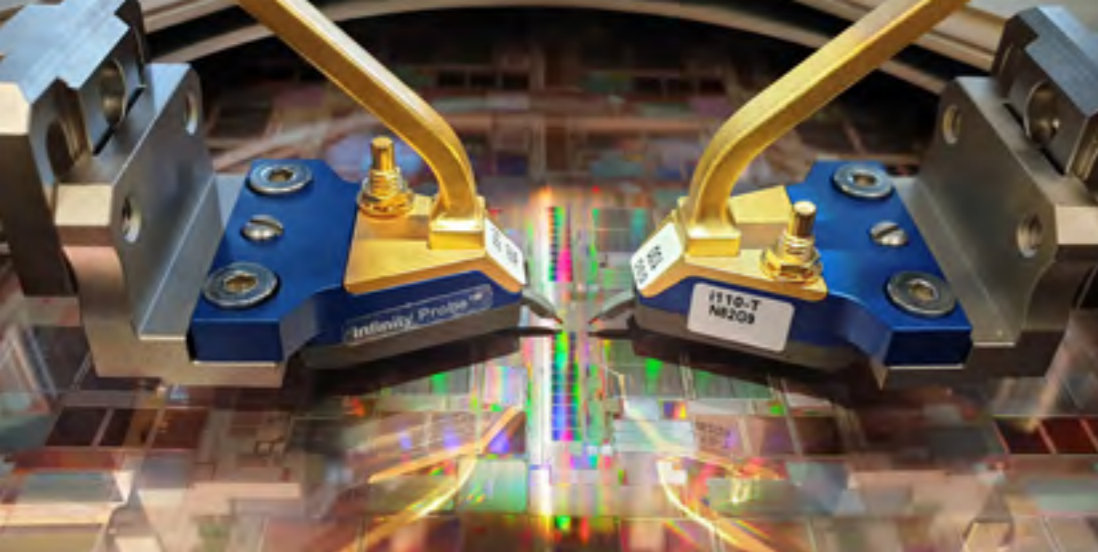
Elektrischer Prober über 300-mm-Wafer und Kontaktierungsspitzen.
