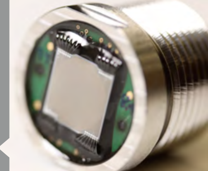
Ultraschall-Sensorkopf auf Basis eines CMUT-Chips mit elektrisch einstellbarem Tiefenfokus.
