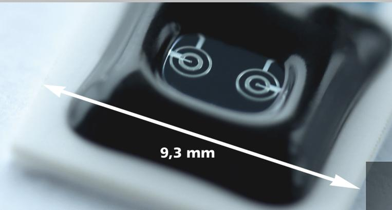
*Elektrochemischer Analytikchip, Variante 6, Verkapselt auf Keramikplatine, für die elektrochemische Messung für Flüssigkeiten.*
