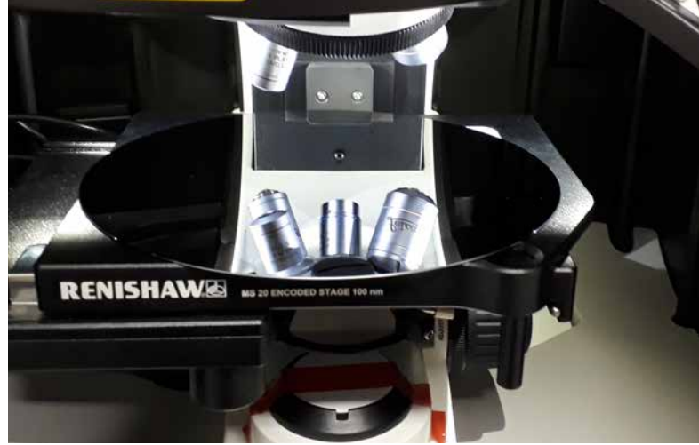
Analyse eines 200 mm Si-Wafers mit 100 nm Positioniergenauigkeit
